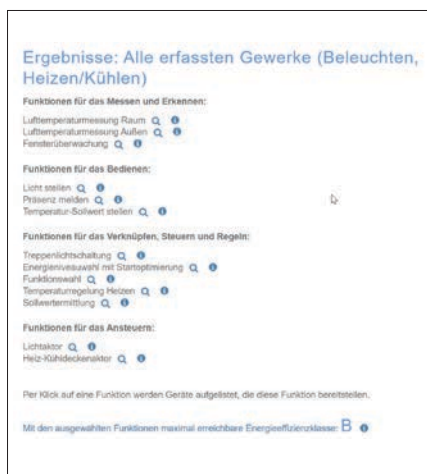
Bild 5: Ermittelte Standardfunktionen nach VDI 3813 für das Konzept, das alle Nutzerwünsche aus Bild 4 erfüllt, sowie die insgesamt für alle Gewerke erreichbare Energieeffizienzklasse (hier B); die blauen Klicksymbole führen zu Texten und Videos, welche diese Funktionen anschaulich erklären
