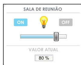
7-Botões de controle da iluminação
