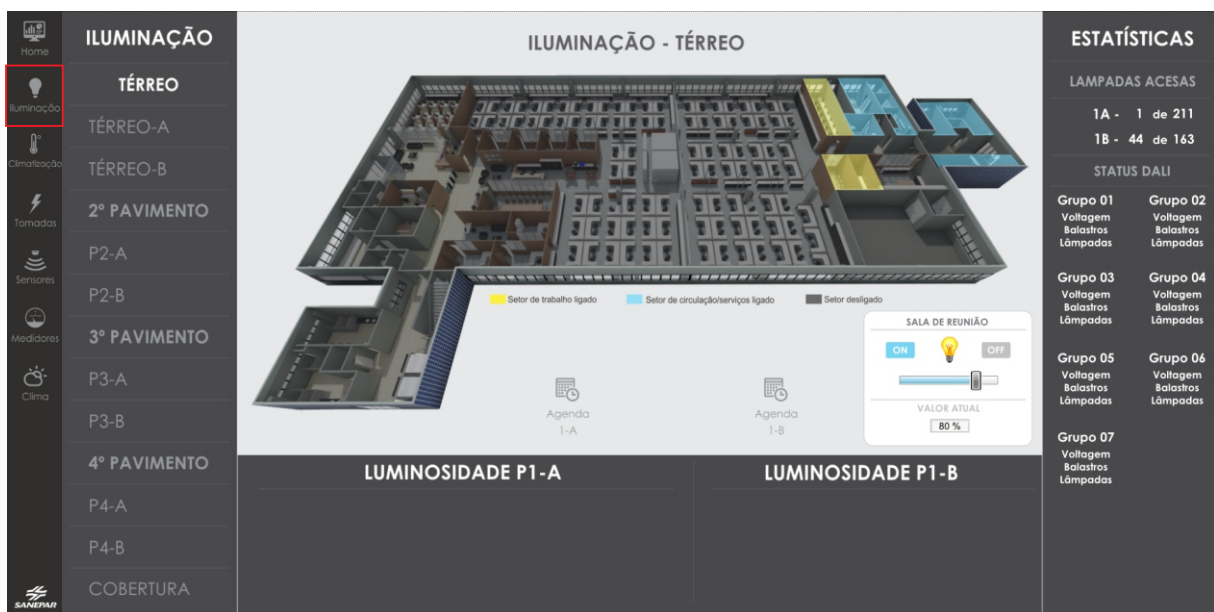
4-Tela de controle da iluminação
