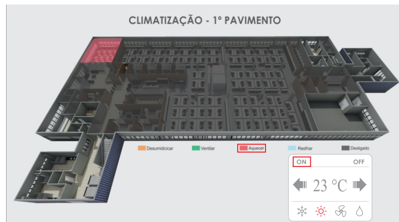
15-Tela de controle da climatização aquecer
