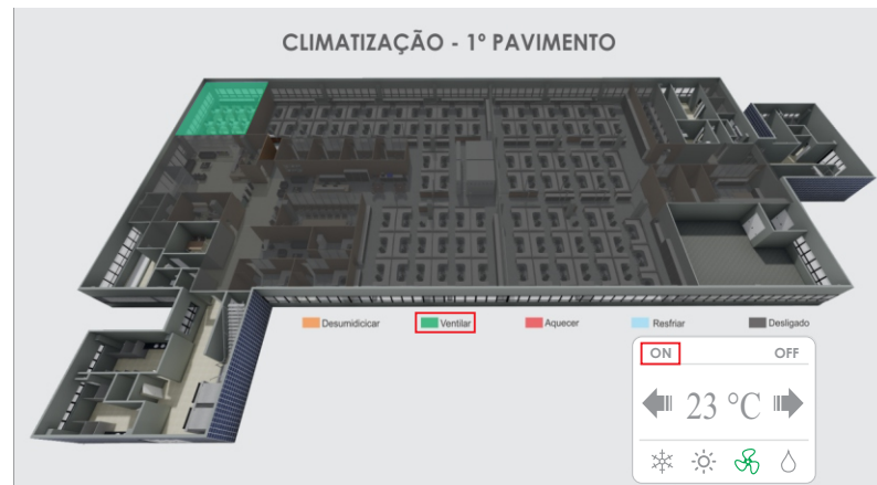
16-Tela de controle da climatização ventilar
