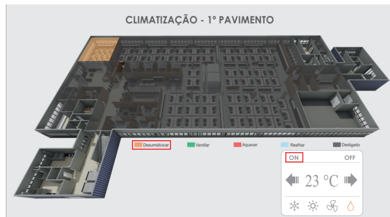
17-Tela de controle da climatização desumidificar
