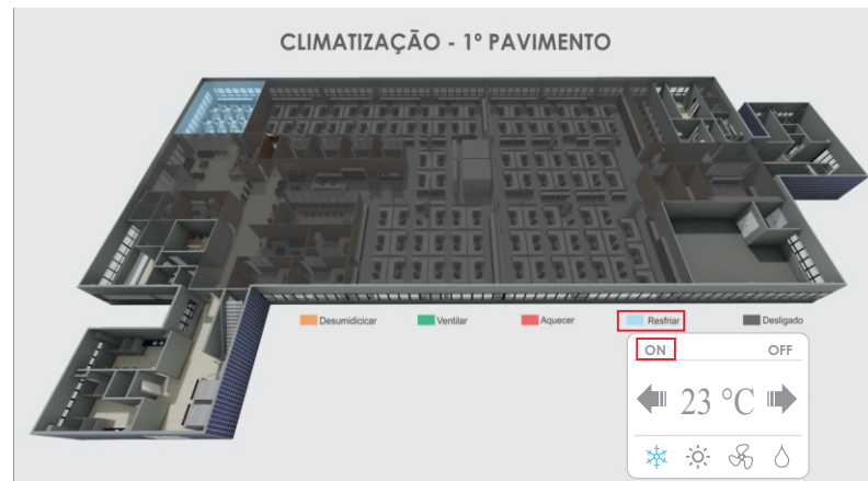
14-Tela de controle da climatização resfriar
