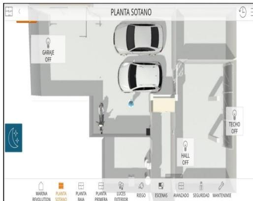
La vivienda cuenta con sensores de movimiento, sistemas de control lumínico que aumentan la vida útil de los focos de bajo consumo LED instalados tanto en su interior como en su exterior y programadores de uso según huso horario o cantidad de lumens; por ejemplo si encendemos una luz exterior de día, la casa la apagará, al subir la escalera el sensor de movimiento enciende la luz solo si es de noche, etc...
